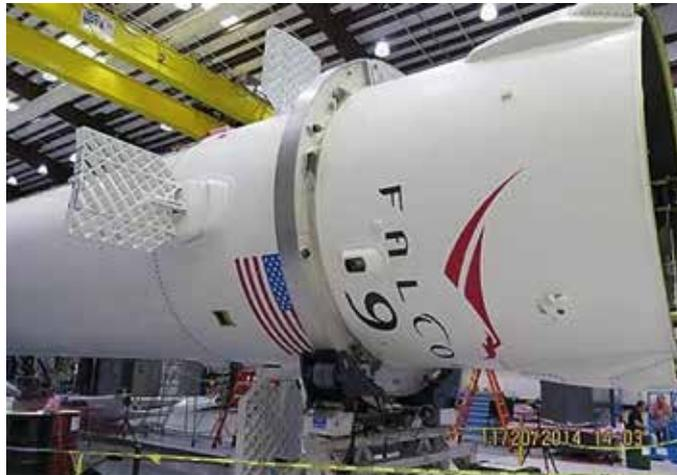
▲ Тестовое раскрытие сверхзвуковых решетчатых «плавников» X-образного расположения, которые будут задействованы при следующем старте ракеты Falcon 9.
