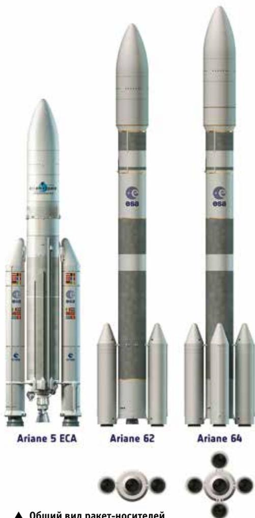
▲ Общий вид ракет-носителей Ariane 5 и Ariane 6 с двумя (A62) и четырьмя (A64) стартовыми ускорителями.
