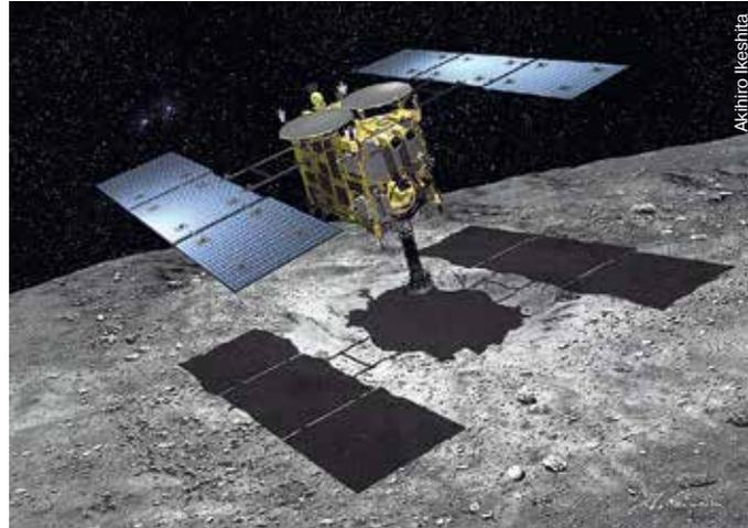
▲ Система отбора проб аппарата «Хаябуса-2» предусматривает сброс на поверхность взрывающегося снаряда. Часть выбитых взрывом обломков будет уловлена специальной воронкой и упакована в контейнер, предназначенный для их доставки на Землю.
